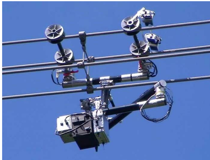
1. ábra Sodronyra felfüggesztett HiBot robot [13]
