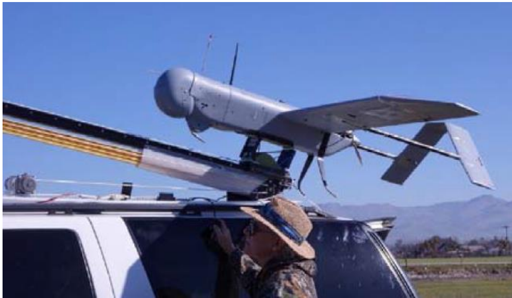
11. ábra Fix szárnyú repülő robot járműre telepített indítóálláson [1]
