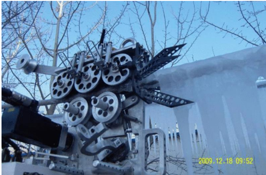
9. ábra A LineROVER robot, amely képes jégteleníteni a sodronyt [15]
