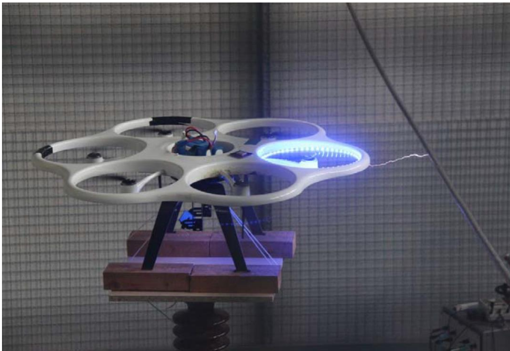
14. ábra Drón EMC teszt közben [14]
